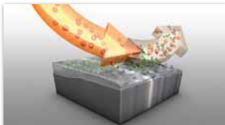
Sfere ceramiche piccole portate via da particelle grosse
