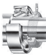
Bild 5. Einpressen einer Abziehhülse in ein Lager, das gegen eine Wellenschulter abgestützt ist
