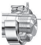
Bild 3. Einbau eines Lagers direkt auf kegeligem Sitz
