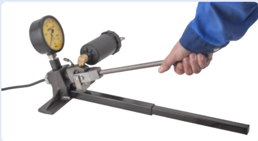
Serie 226400 E utilizzata con blocco adattatore, manometro e tubo per alta pressione.
