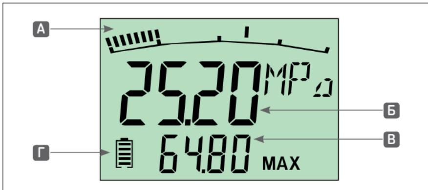
Фактическое давление отображается на дисплее. Измеренное давление отображается на дисплее в соответствующих единицах. Значение MAX или FS отображается в нижней части дисплея.
