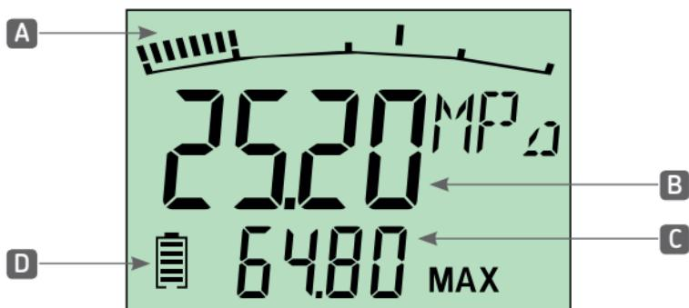
La pressione effettiva viene indicata nella modalità display. Il valore misurato viene visualizzato nell'unità corrispondente. Il valore MAX o FS è indicato nella parte inferiore del display.
