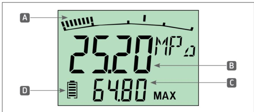
A pressão real é indicada no modo de exibição. O valor medido é exibido na unidade correspondente. O valor de MAX ou FS é indicado no lado inferior da tela.
