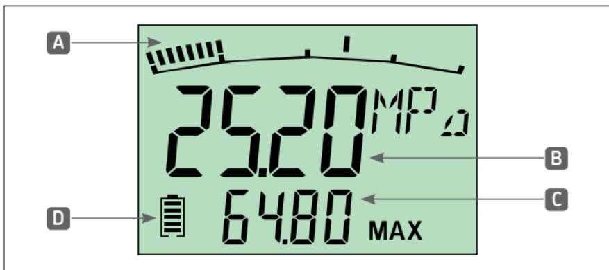
Der aktuelle Druck erscheint im Anzeigemodus. Der gemessene Wert wird in der entsprechenden Einheit angezeigt. Der MAX- bzw. FS-Wert (Vollausschlag) erscheint im unteren Teil der Anzeige.
