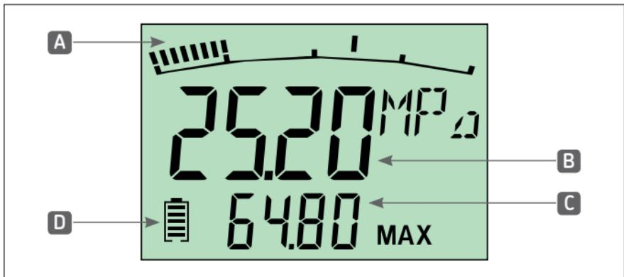
实际压力在显示模式下显示。测得值以相应的单位显示。MAX 或 FS 值在显示屏的下部显示。
