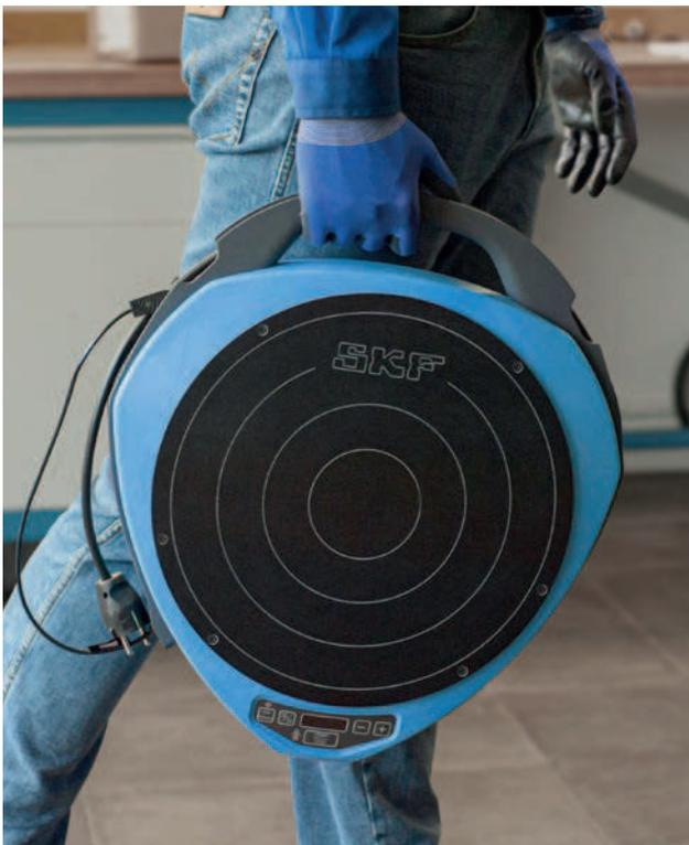
Questo dispositivo ad azionamento elettrico presenta una struttura in fibra di vetro resistente alle alte temperature, che consente una bassa differenza di temperatura tra gli anelli interno ed esterno del cuscinetto. Ciò contribuisce a ridurre le sollecitazioni interne che si generano a causa dell'eccessiva dilatazione termica dell'anello interno rispetto a quello esterno.
