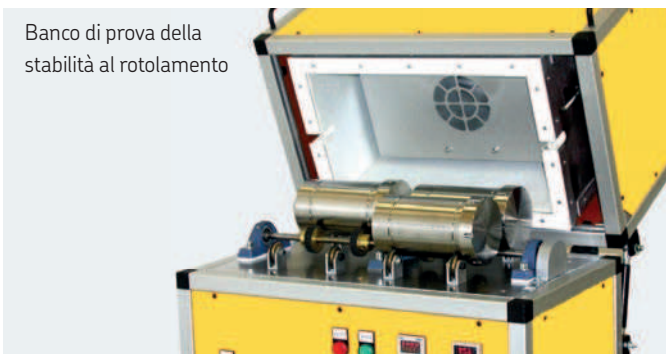
Banco di prova del grasso Emcor
