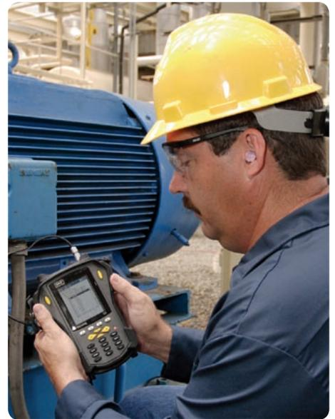
*Registrazione dei valori di vibrazione mediante un dispositivo di acquisizione dati della serie Microlog della SKF*
