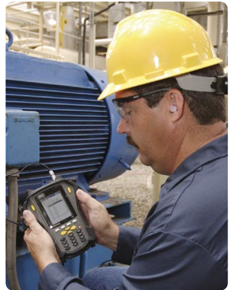
Rilevamento dei valori di vibrazione, utilizzando gli strumenti di acquisizione dati della SKF della serie Microlog
