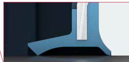
**Dinamica:** Una tenuta a doppio labbro con interferenza sufficiente per compensare 1 grado di disallineamento.
