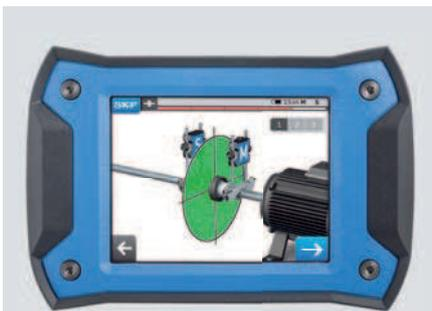
Grazie alla funzionalità di misurazione libera è possibile iniziare le misurazioni di allineamento a qualsiasi angolazione terminando con uno spettro angolare di appena 90°.
