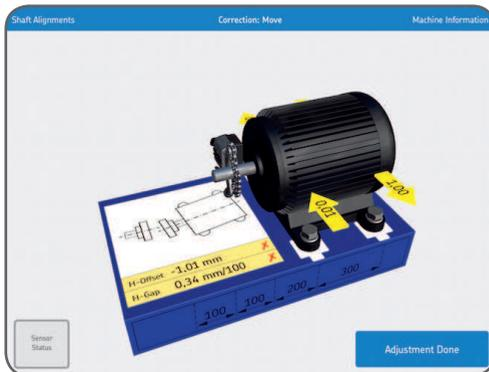
Dopo aver eseguito la correzione, o se non è necessaria alcuna correzione, selezionare “Regolazione eseguita”.
