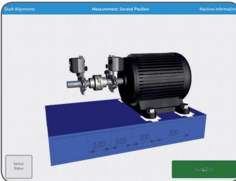
*Quando il sistema rileva nuovamente che l'albero è stato ruotato di un'entità sufficiente, ed è stato lasciato in quella posizione per un breve periodo di tempo, registra automaticamente la 3° posizione di misurazione.*
