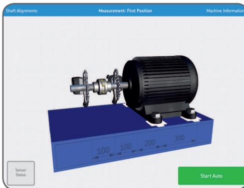
*Quando il sistema rileva che l'albero è stato ruotato di un'entità sufficiente, ed è stato lasciato in quella posizione per un breve periodo di tempo, registra automaticamente la 2° posizione di misurazione.*
