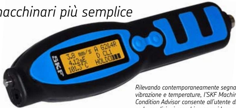
*Rilevando contemporaneamente segnali di vibrazione e temperature, l'SKF Machine Condition Advisor consente all'utente di stabilire se le condizioni macchina sono idonee oppure sono presenti danni ai cuscinetti.*
