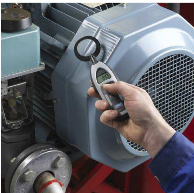
I motori elettrici sono maggiormente soggetti a subire l'erosione elettrica dei cuscinetti quando sono controllati da un Comando a Frequenza Variabile (inverter). Il TKED 1, qualora sia utilizzato all'interno di un programma di manutenzione predittiva, può aiutare a individuare i cuscinetti maggiormente predisposti al cedimento e a prevenire in modo significativo tempi di fermo macchina non programmati.
