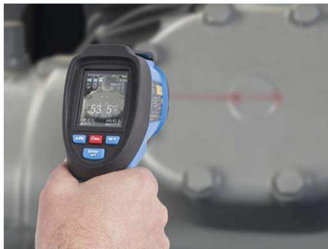
Qualora usato in modalità non a contatto, il termometro percepisce l'energia termica irradiata da un oggetto con un rilevatore ad infrarossi. Se puntato verso un oggetto, il rilevatore a infrarossi raccoglie energia, producendo un segnale che il microprocessore traduce in una lettura sul display retroilluminato. Se si tiene il grilletto premuto, il rilevatore a infrarossi continua a misurare la temperatura dell'oggetto. Ciò consente letture rapide e precise in tempo reale.
