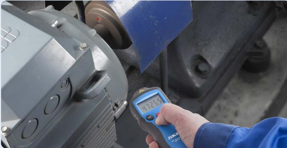
Il sistema ottico al laser permette di eseguire le misurazioni in modo facile e rapido a una distanza di sicurezza dai macchinari rotanti
