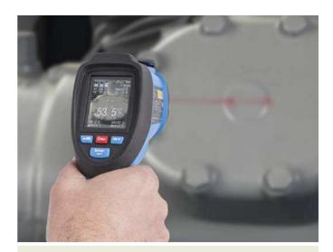
Qualora usato in modalità non a contatto, il termometro percepisce l'energia termica irradiata da un oggetto con un rilevatore ad infrarossi. Se puntato verso un oggetto, il rilevatore a infrarossi raccoglie energia, producendo un segnale che il microprocessore traduce in una lettura sul display retroilluminato. Se si tiene il grilletto premuto, il rilevatore a infrarossi continua a misurare la temperatura dell'oggetto.
