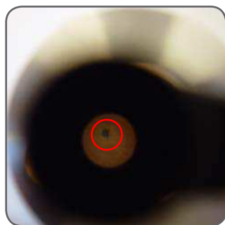
Particella nera (a causa ad es. di ossidazione, tenute, ecc.)
