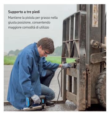
Il display dello strumento visualizza il livello di carica della batteria, la quantità di grasso erogato, la velocità della pompa/motore e avverte l'operatore se si trova di fronte a punti di lubrificazione ostruiti. Queste versatili pistole per grasso offrono due velocità - bassa o alta portata - e hanno un'autonomia di erogazione fino a 15 cartucce di grasso per carica. Le TLGB 20 sviluppano pressioni fino a 700 bar e sono dotate di luce incorporata per illuminare l'area di lavoro.
