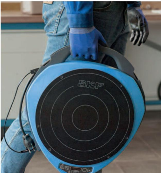
Questo dispositivo ad azionamento elettrico presenta una struttura in fibra di vetro resistente alle alte temperature, che consente una bassa differenza di temperatura tra gli anelli interno ed esterno del cuscinetto. Ciò contribuisce a ridurre le sollecitazioni interne che si generano a causa dell'eccessiva dilatazione termica dell'anello interno rispetto a quello esterno.
