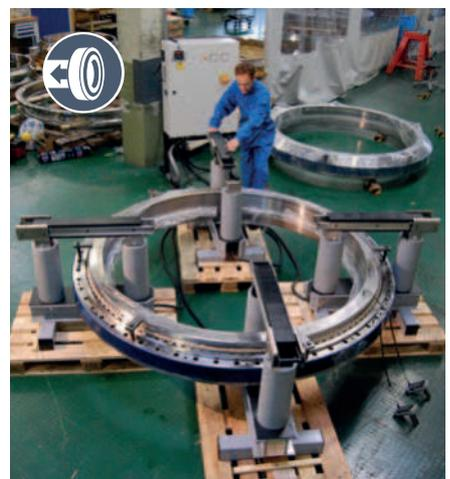
La SKF può configurare il tipo di riscaldatore della serie TIH MC necessario in base all'applicazione. Per ulteriori informazioni, contattate il vostro distributore autorizzato SKF
