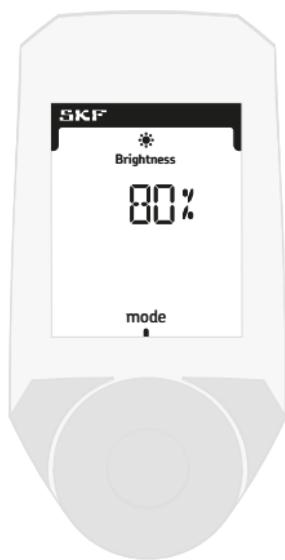
*Ajuste la luminosidad mediante el desplazamiento de la rueda. La luminosidad también se denomina "Duración del destello": cambia el tiempo de encendido ("on") de la luz intermitente, lo que puede causar una imagen borrosa si es demasiado brillante.*
