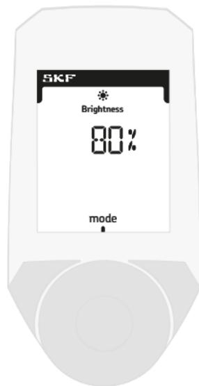
*Mit dem Drehrad stellen Sie die Helligkeit ein. Die Helligkeit entspricht der Blitzdauer. Bei zu starker Helligkeit wird das Bild unscharf.*
