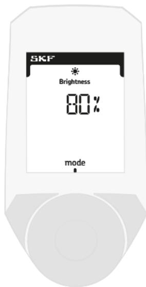
*Réglez la luminosité en faisant défiler la roue. La luminosité est également appelée « durée du flash » : elle modifie la durée pendant laquelle la lumière clignotante est allumée et peut entraîner une image floue si elle est trop élevée.*
