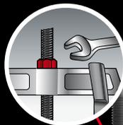
• Bloccaggio del dado esagonale mediante chiave.
