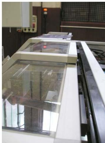
Applicazione su carter scorrevoli in senso orizzontale. Trattasi della protezione fine linea di una macchina automatica.
