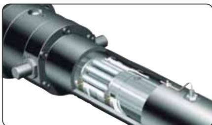
I cilindri elettromeccanici ad elevate prestazioni sono costituiti da una vite SKF a rulli satelliti in presa diretta con un motore brushless. La vite a rulli satelliti converte il movimento da rotatorio a traslatorio.
